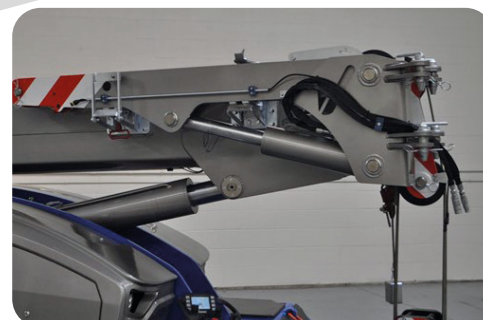
SWING AWAY HYDRAULIC JIB Flechette pliable faltbarer Ausleger / Pluma plegable
