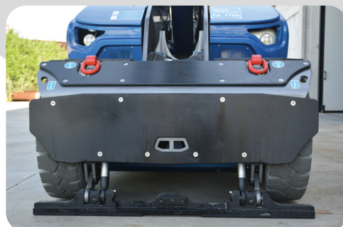
STABILIZER CROSSBAR Barre stabilisatrice Vorderradabstützung / Barra estabilizadora
